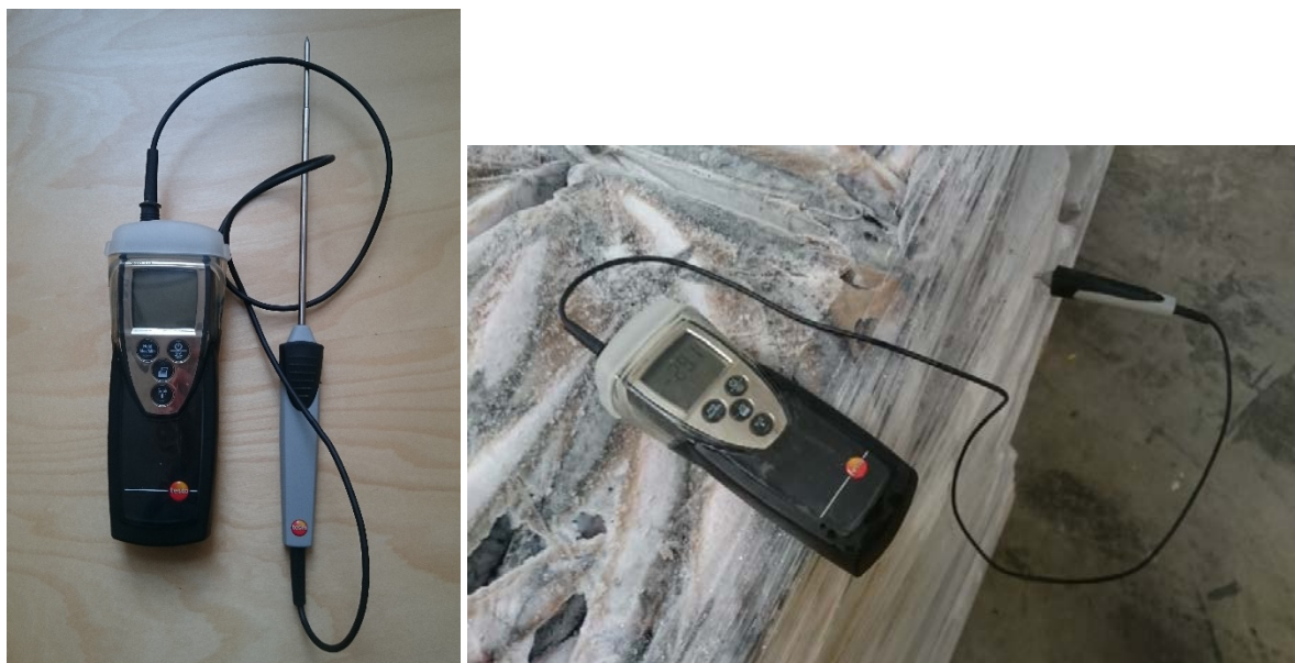
Figur 2 Innstikkstermometer og hvordan den ble brukt for måling av temperatur i blokkene før tining.
