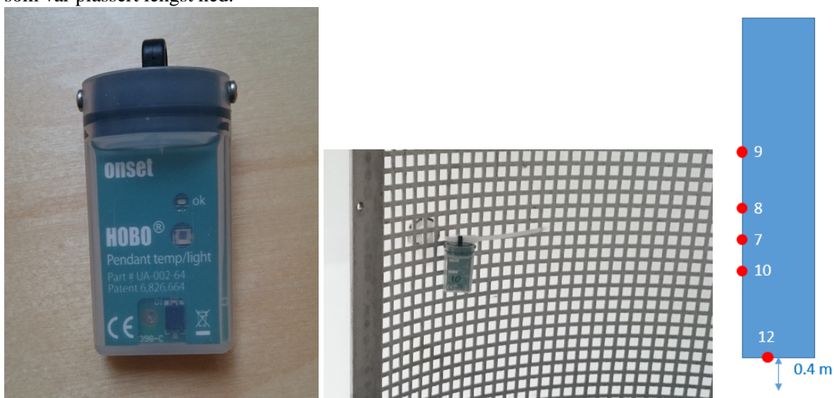
Figur 1 HOBO temperaturlogger, hvordan den ble festet og hvor de 5 loggerne ble plassert
